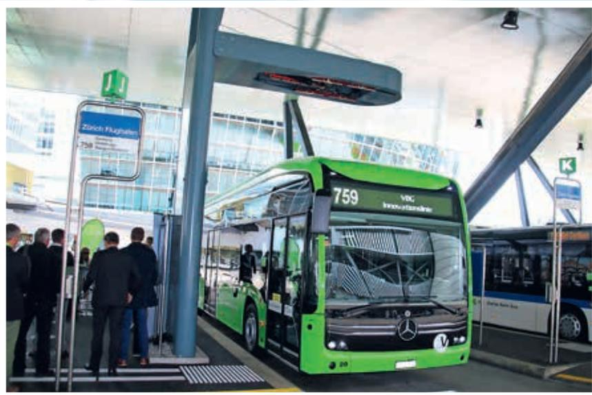
Die drei Türen des Solobusses gewährleisten einen schnellen Fahrgastfluss an den Haltestellen. Zur Entlastung des Fahrpersonals sind alle Türen mit einer Türautomatik ausgestattet. Ohnehin hat die VBG das Wohl der Fahrer im Auge, das zeigt die Ausstattung mit einem klimatisierten und beheizten Fahrersitz, elektromotorisch einstellbarer Lendenwirbelunterstützung sowie einer Kühlbox.
